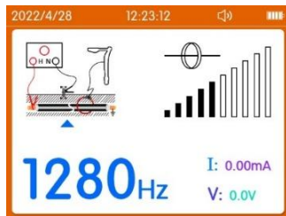
图 4-10 电缆识别信号发射界面
