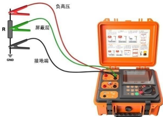
图 7-8 绝缘电阻测量接线（带屏蔽）
