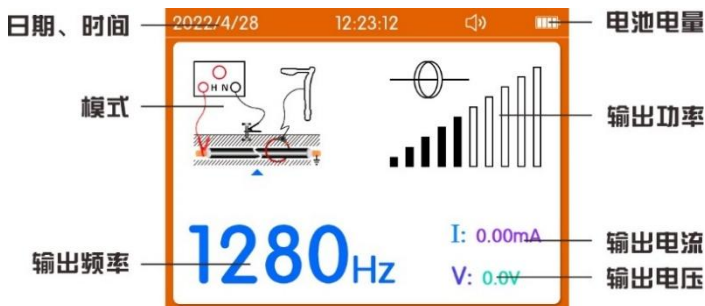
图 5-2 电缆识别模式直连法输出界面图
