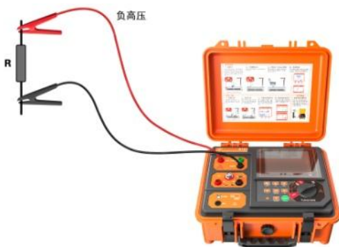
图 7-7 绝缘电阻测量接线（无屏蔽）
