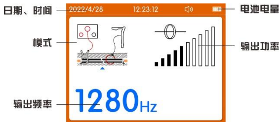
图 5-15 电缆识别模式卡钳耦合输出界面
