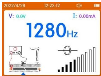
图 4-9 管线探测信号发射界面
