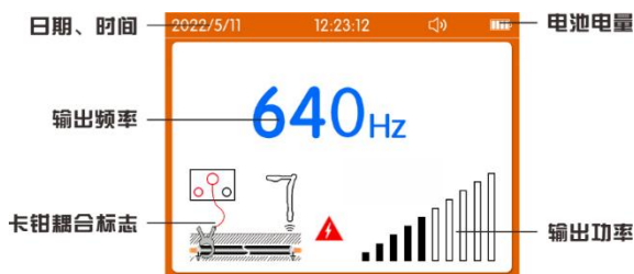
图 5-14 管线探测模式卡钳耦合输出界面
