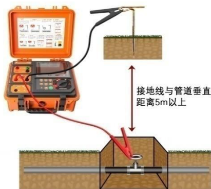
图 5-4 金属管道直连法接线图
