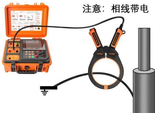
图 5-19 运行电缆卡钳耦合法 2 (卡电缆接地线)
