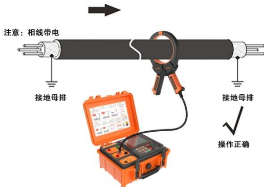
图 5-17 运行电缆卡钳耦合合法 1（卡电缆本体）
