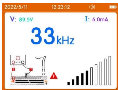
图 5-3 直连法未连接输出界面图
