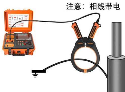
图 5-17 运行电缆卡钳耦合法 2（卡电缆接地线）
