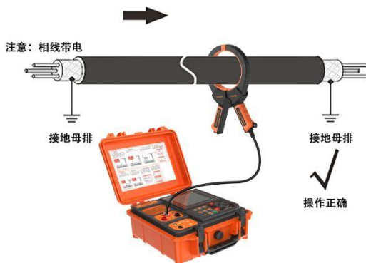
图 5-15 运行电缆卡钳耦合合法 1（卡电缆本体）
