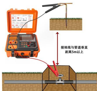
图 5-3 金属管道直连接线图
