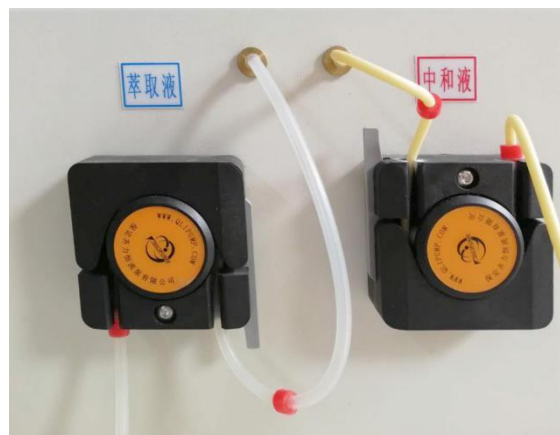
图 3 萃取液及中和液蠕动泵
