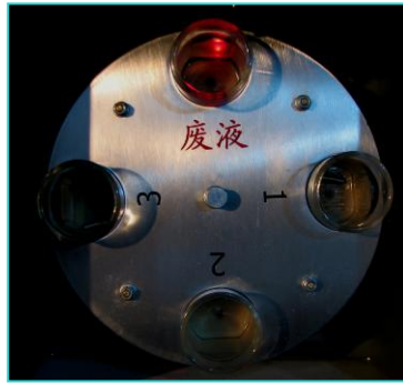
图 2 油样测定暗室
