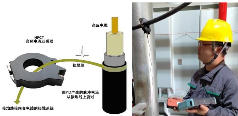
HFCT 接线方式及使用方法
