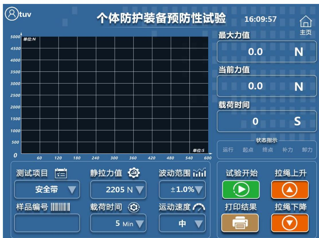
(2) 选择待测试项目并设定参数，根据标准要求，静拉力值会自动弹出对应的“静拉力值”与“载荷时间”（注：在选择其它时，力值可自定义）；根据实际需要，选择波动范围值；输入样品编号以及运动速度。
